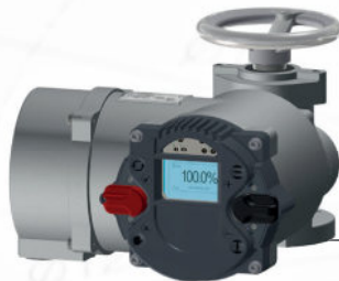
CM-DREHANTRIEB CM ROTARY ACTUATOR Drehmomente bis 128 Nm z. B. für Schieber bis ca. Nennweite 200 Ausgangsdrehzahl 2,5 bis 72 U/min Torques up to 128 Nm Example: gate valves up to DN 200 Output speed: from 2.5 RPM to 72 RPM
